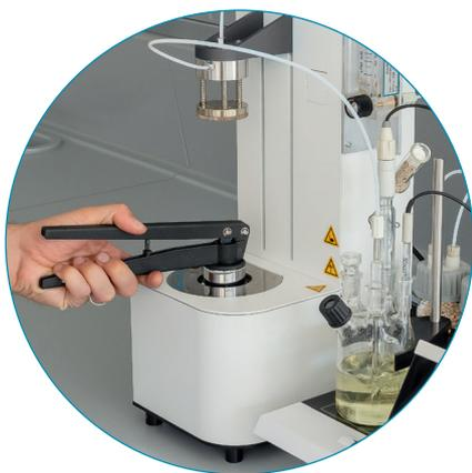
Warum halbautomatisch? Der Anwender stellt die Probe mit der Bördelzange in den Ofen und startet am Titrator oder (optional) an der Software TitriSoft die Methode. Von der Eingabe der Probenbezeichnung und ggf. der Einwaage abgesehen ist das alles, was er für die nächsten Minuten tun muss.
